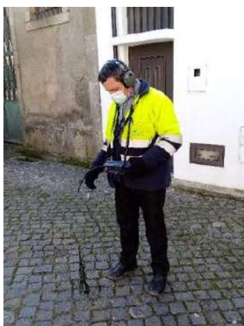
Figura 11 - Pesquisa Ativa de Fugas de Água
